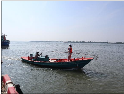
รูปที่ 2-1 เรือเล็กขนาดเครื่องยนต์ 24 แรงม้าใช้ในการลากบูม (Boom)
